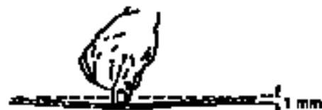
Abb. 1: Einstellung der Blattspannung
